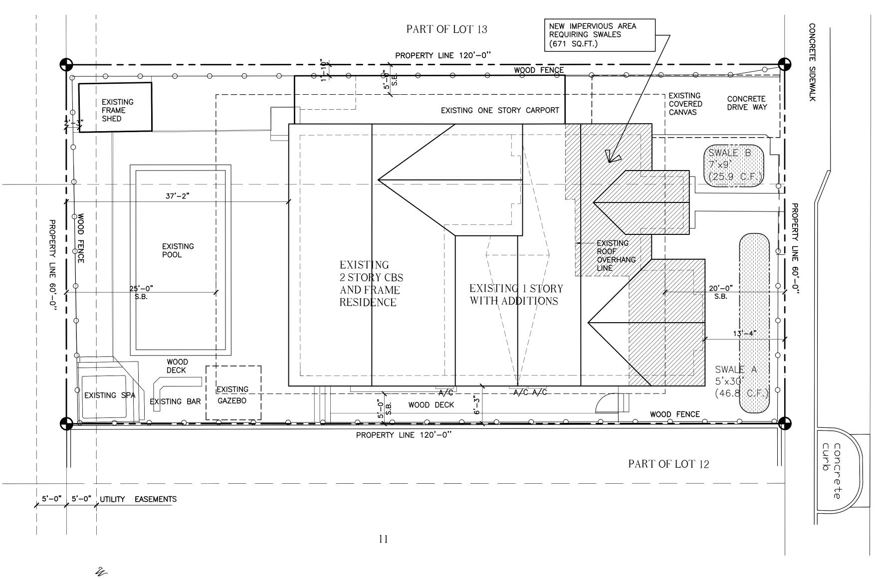
SWALES - DRAINAGE SITE PLAN
