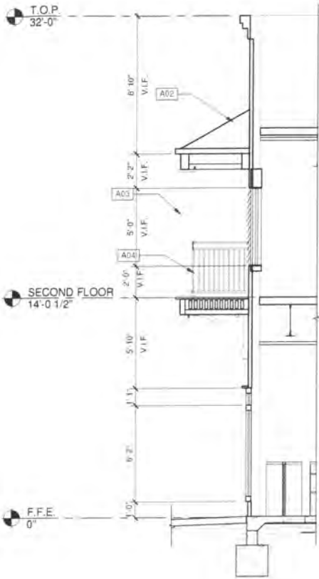
WALL SECTION 2 SCALE: 1/4" = 1'-0"
