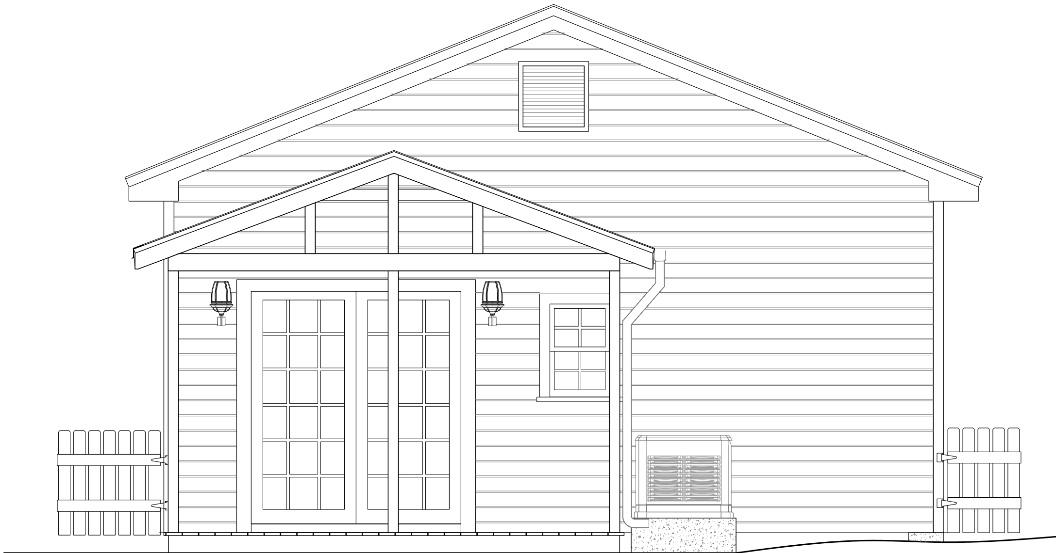
EXISTING REAR ELEVATION SCALE: 3/8" = 1'-0"
