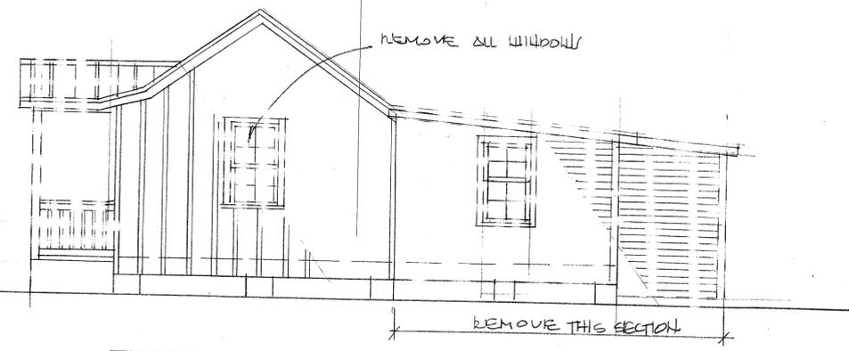
EXISTING/DEMOLITION SIDE ELEVATION
