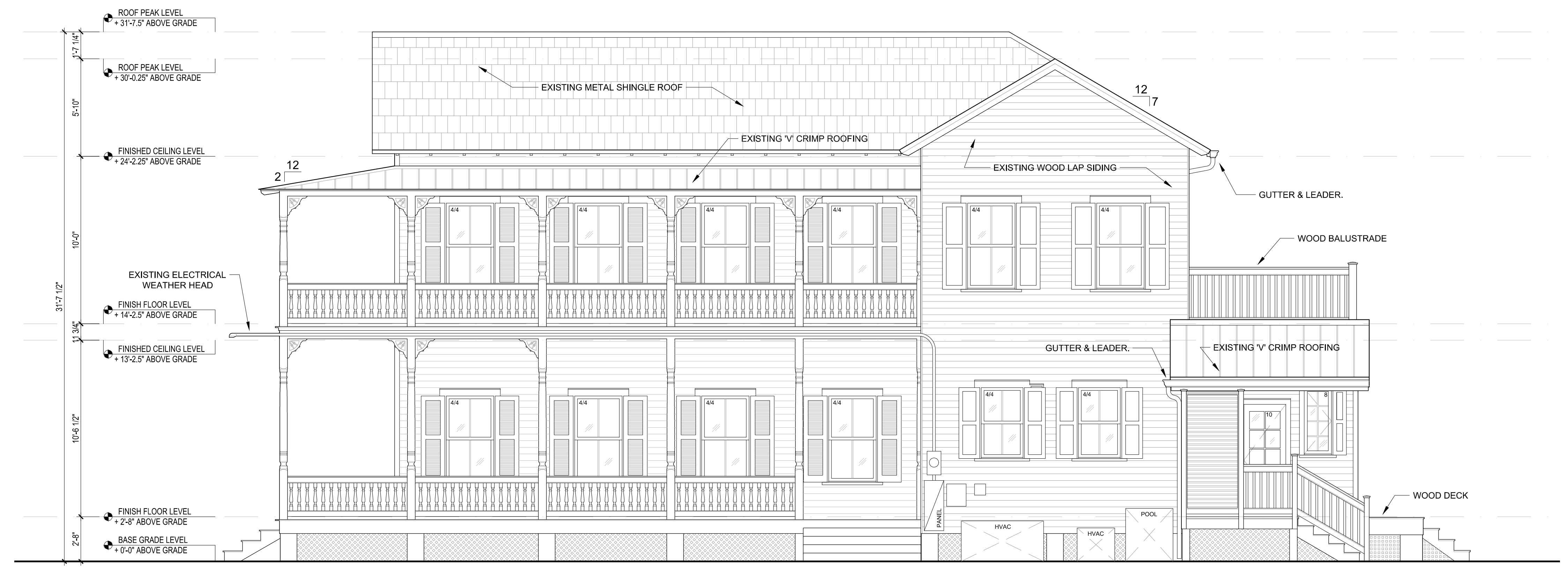
2 SIDE ELEVATION SCALE: 1/4" = 1'-0" GRAPHIC SCALE: 1/4" = 1'-0"
