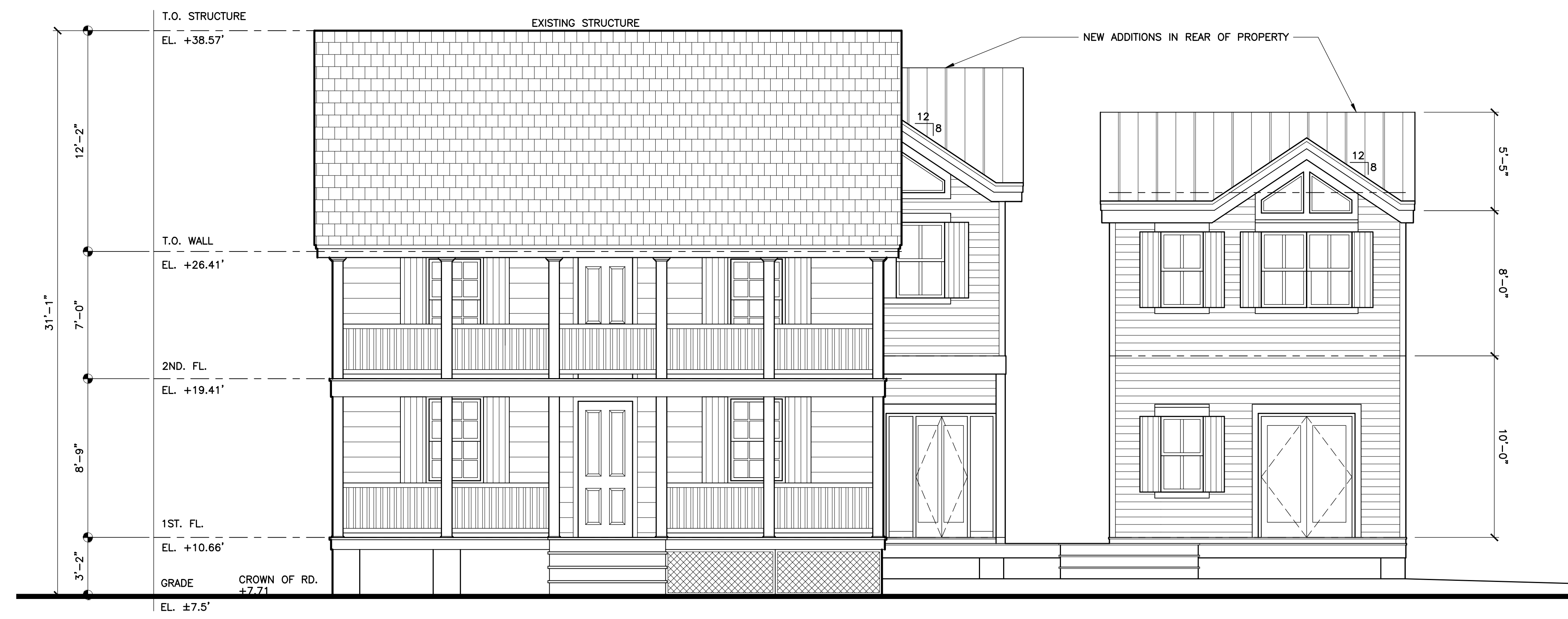
1 A-6 FRONT ELEVATION SCALE: 1/4"=1'-0"
