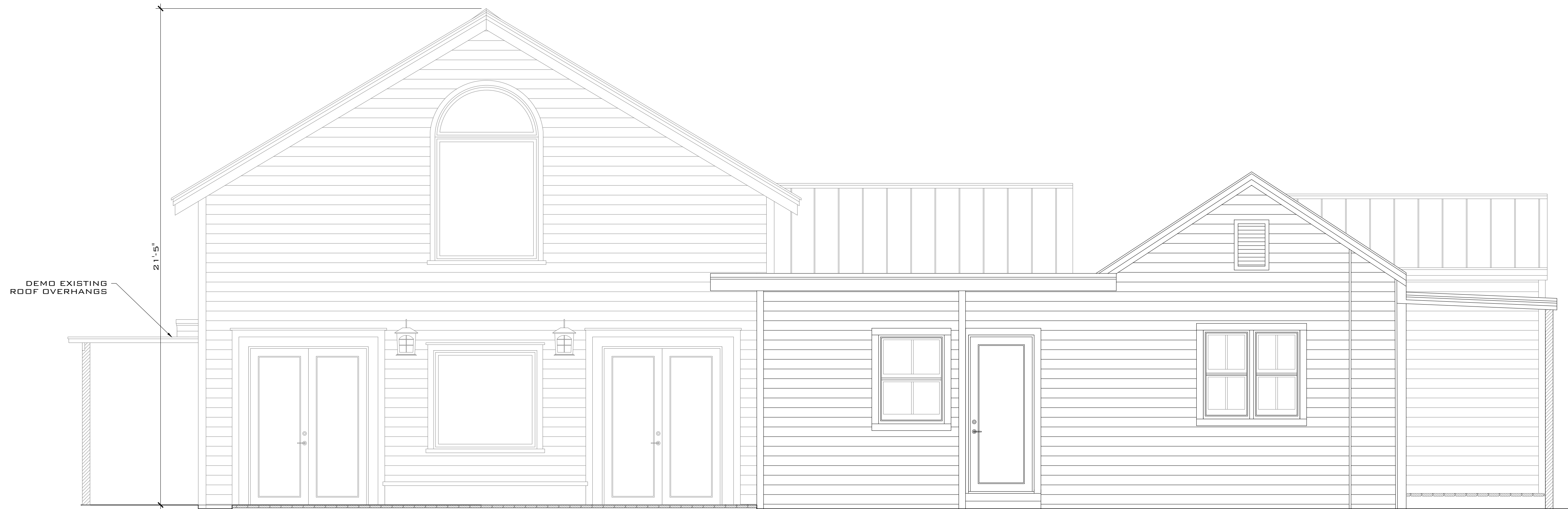
EXISTING FRONT ELEVATION SCALE: 3/8" = 1'-0"
