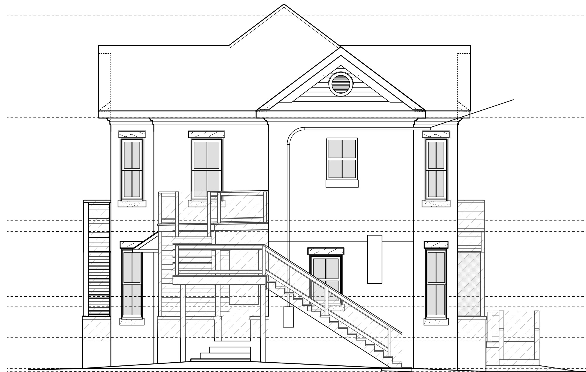
2 D1.1 ELEVATION DEMOLITION SCALE: 3/16" = 1'-0"
