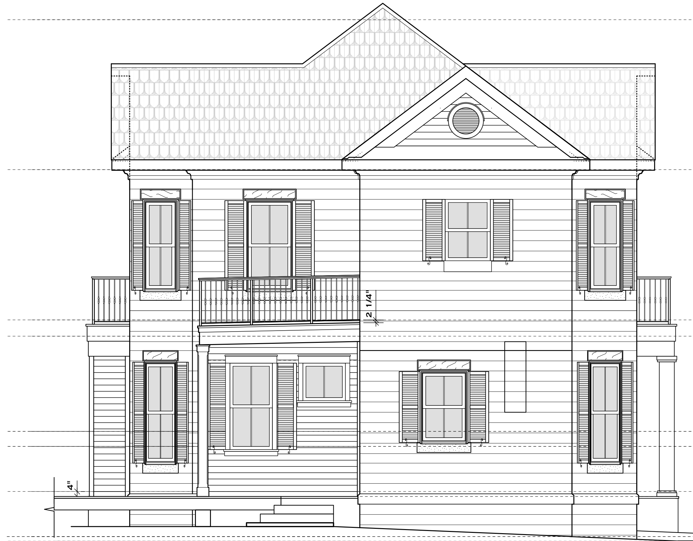
1 BACK ELEVATION A3.2 SCALE: 1/4" = 1'-0"
